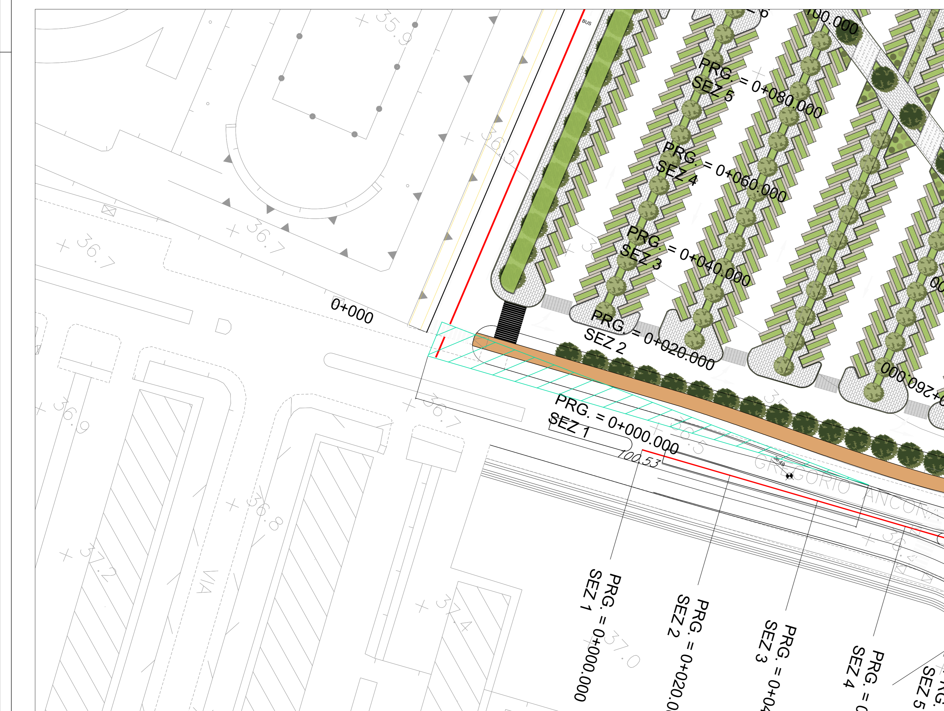
Intersezione a progressiva 0+000.00 Triangoli di visibilita' SCALA 1:500
