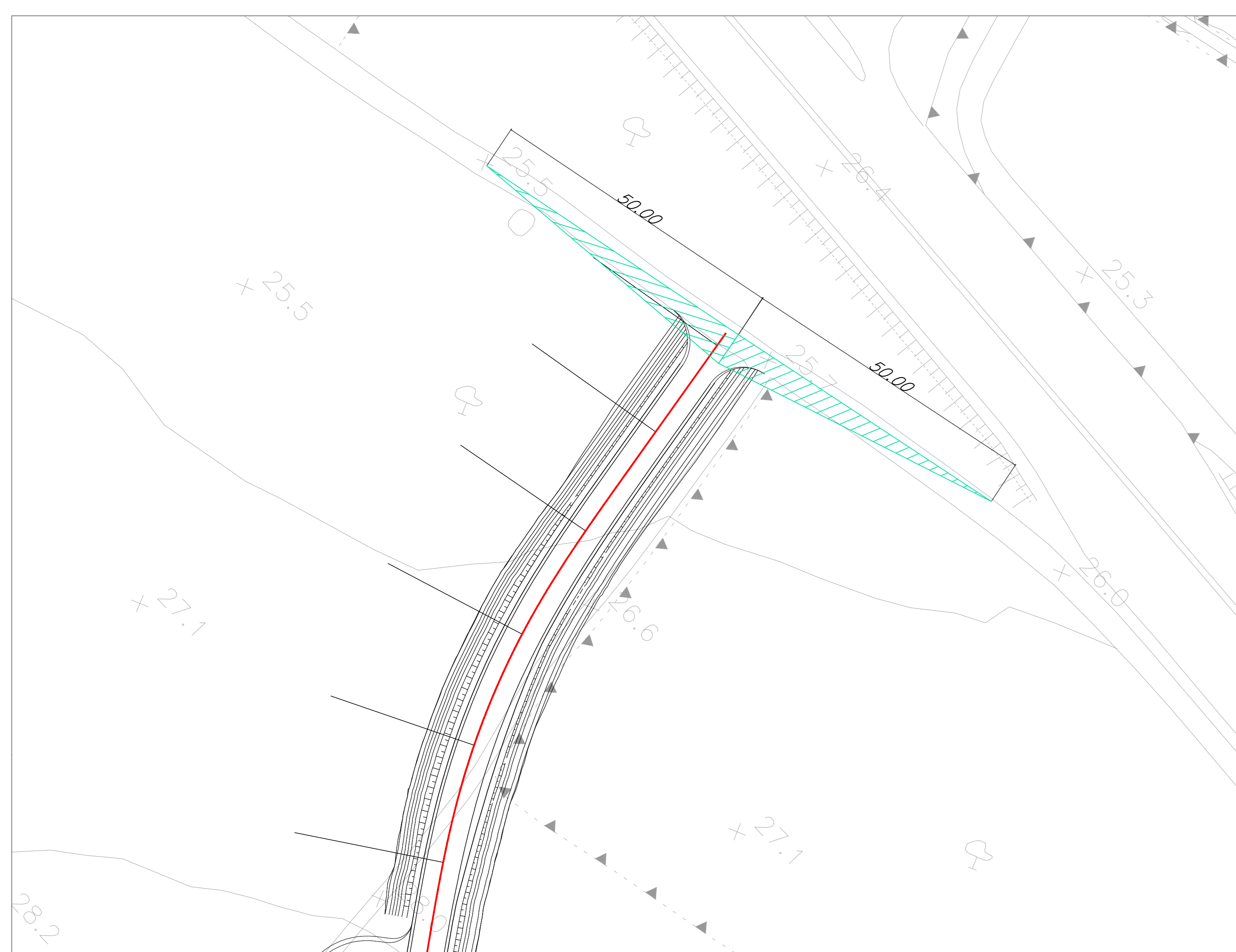
Intersezione a progressiva 0+002.50 Triangoli di visibilita' SCALA 1:500
