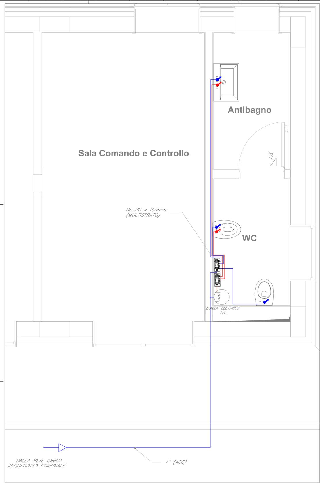
LAYOUT ADDUZIONE impianto IDRICO SANITARIO FABBRICATO T3A scala 1:20
