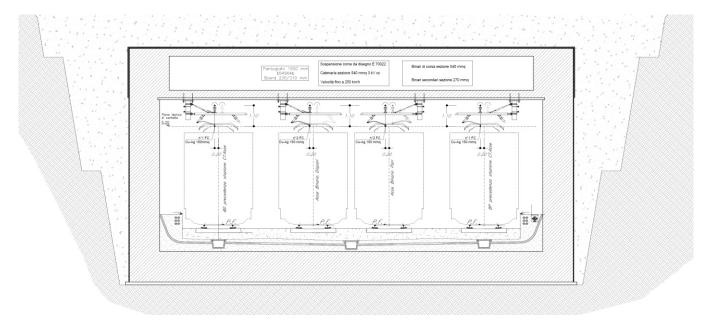
Le grappe in acciaio per il fissaggio dei supporti penduli saranno ancorate alla volta con l'impiego di aggrappanti chimici, ed isolate dal possibile contatto con l'armatura delle strutture mediante l'impiego di opportune boccole distanziali in materiale isolante (a tal proposito vedasi specifica **RFI DTC STS ENE SP IFS TE 673**).
