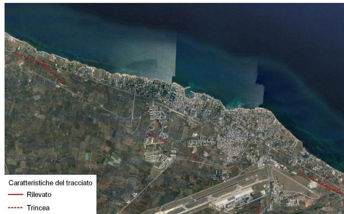
Figura 5-11 Sviluppo del tracciato ferroviario in esame
