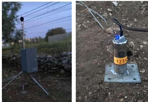
Figura 4-3 Esempio di installazione dell'accelerometro
