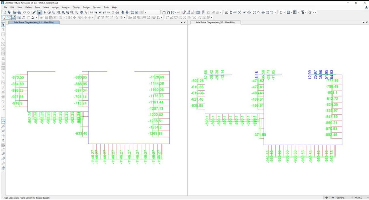
**Figura 10-3: involuppo sforzo assiale SLU e SIS**
