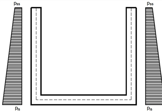
**Fig. 6** – Schema tipo spinta terreno su pareti
