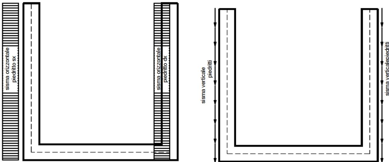
**Fig. 9** – Schema tipo azioni sismiche orizzontali e verticali
