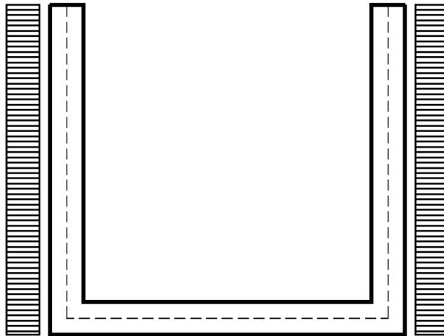
**Fig. 8** – Schema tipo spinta carico accidentale su entrambi le pareti
