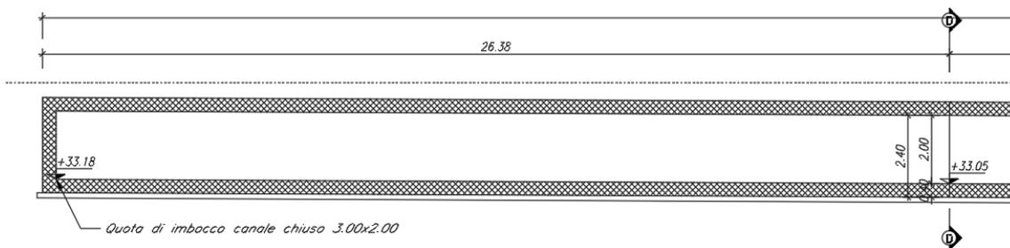
**Fig. 2** – Stralcio di sezione longitudinale dello scatolare
