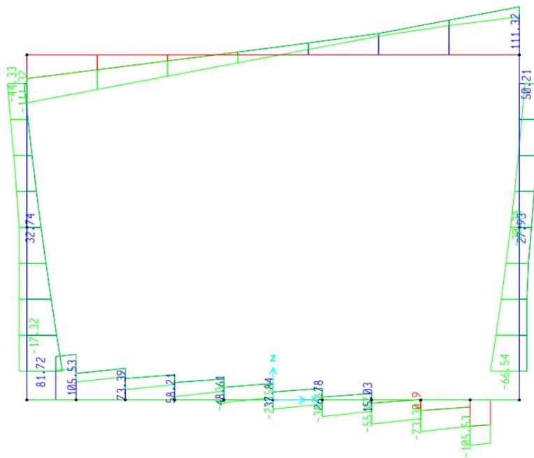
**Fig. 13 – Involuppo sforzi taglianti SLU-SLV**
