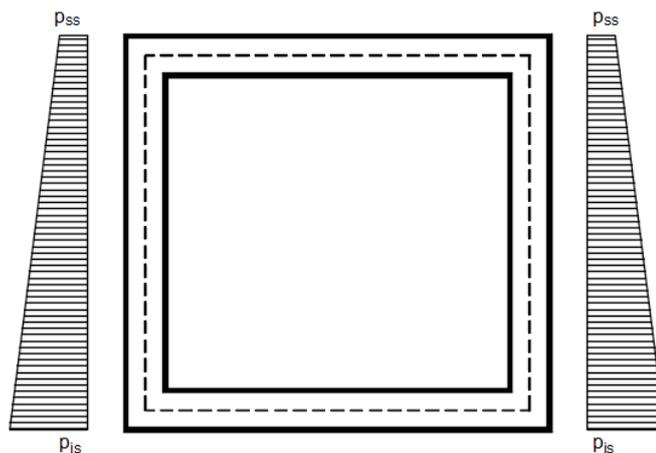
**Fig. 8** – Schema tipo spinta terreno su pareti
