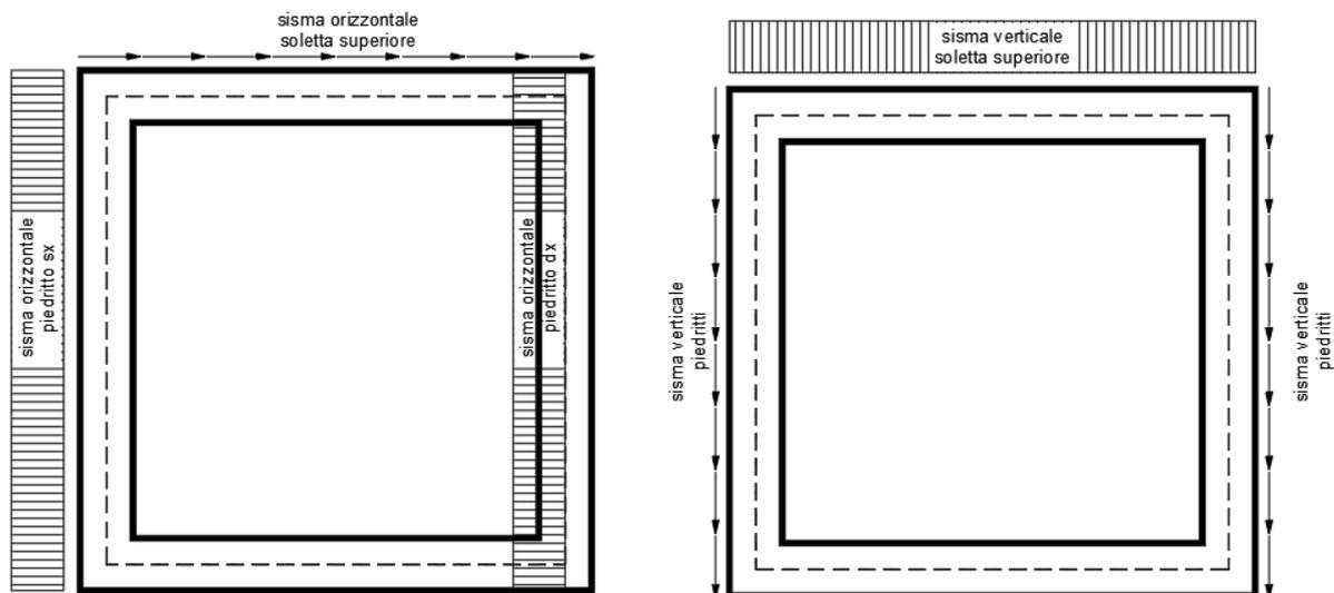
Fig. 11 – Schema tipo azioni sismiche orizzontali e verticali
