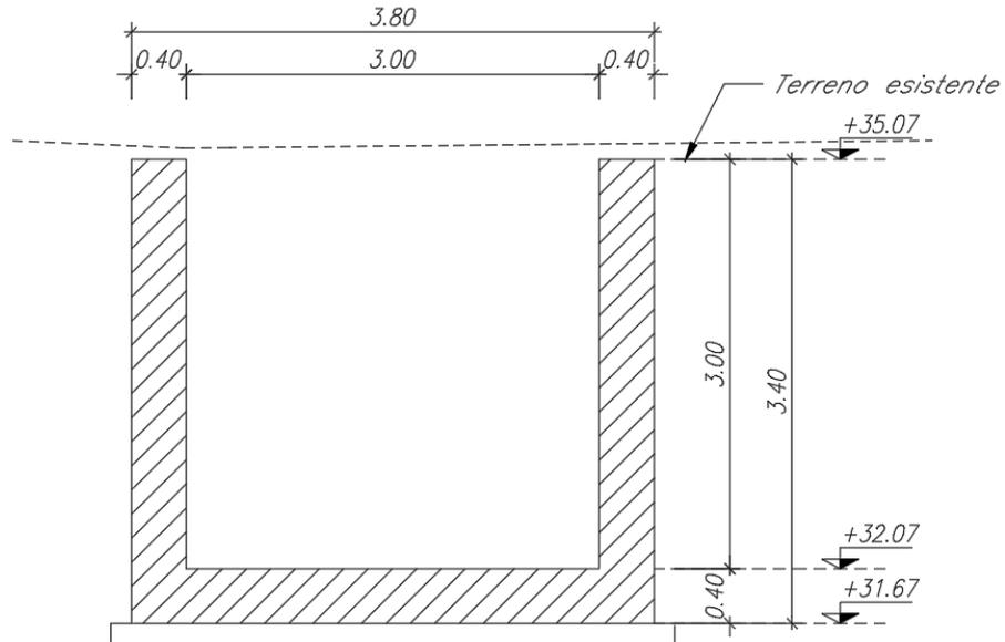
**Fig. 3** – Sezione trasversale del muro a U
