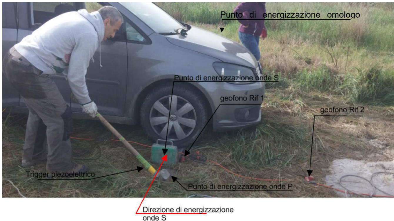
Figura 7.1 Immagine degli apparati di energizzazione
