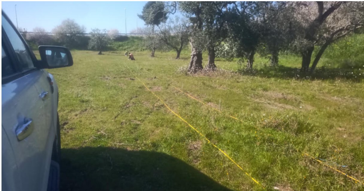
Particolare indagini elettrica tomografica TE8
