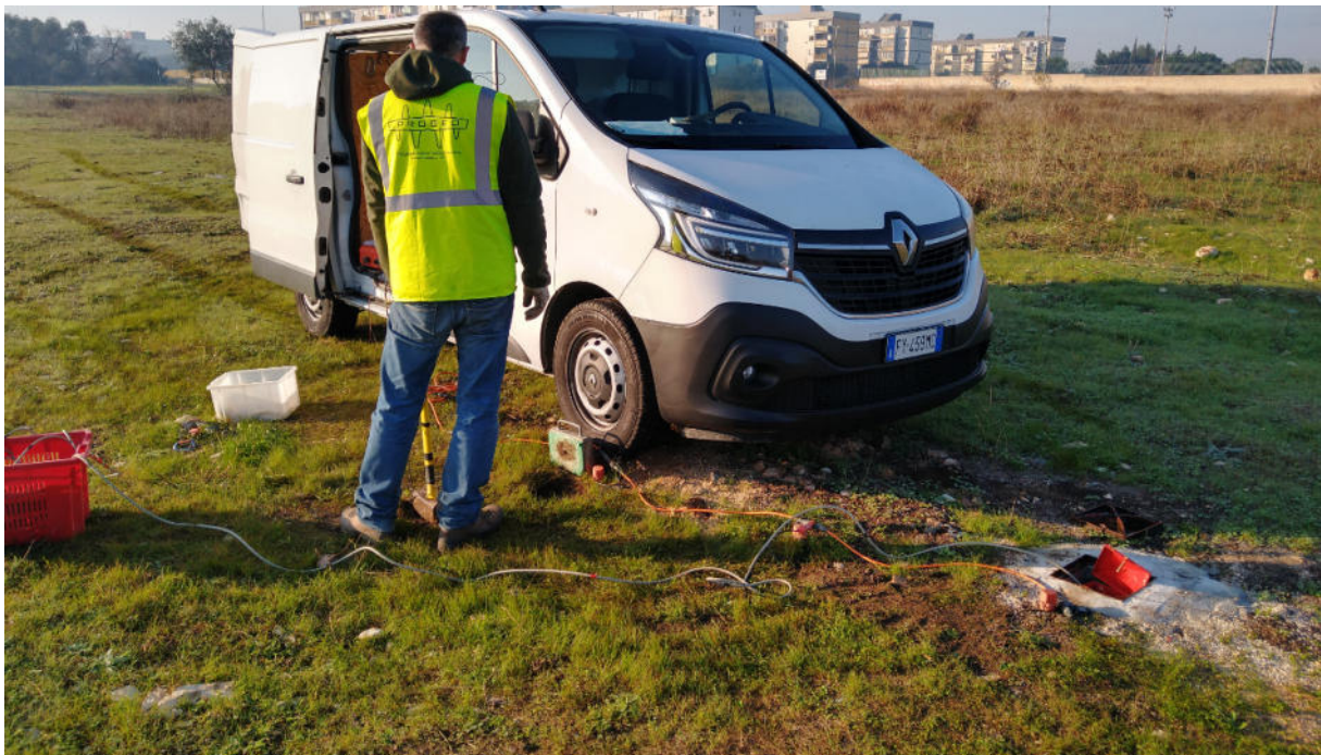
Particolare indagini in foro Down Hole GA03_
