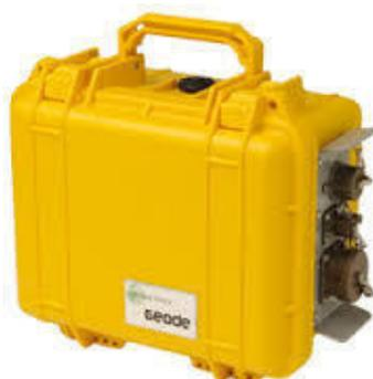
Figura 4 - Sismografo GEODE (Geometrics).
