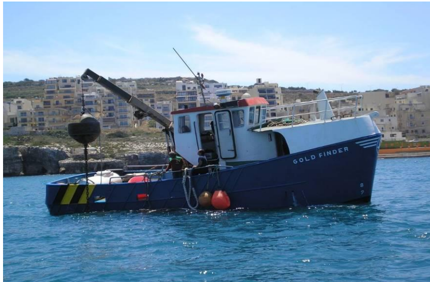
Figura 4-7 - Campionamenti con Benna Van Veen
