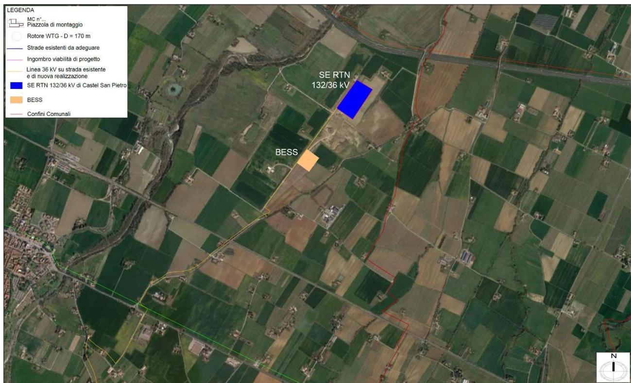
Figura 2.3.3.1: Localizzazione SE 132/36 kV e BESS su ortofoto
