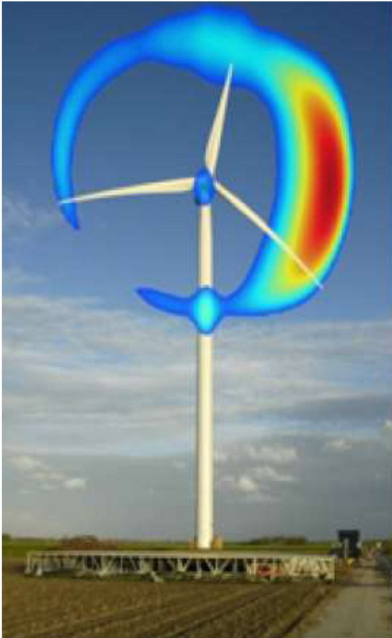
Rumore rilevato con SISTEMA BEAMFORMING
