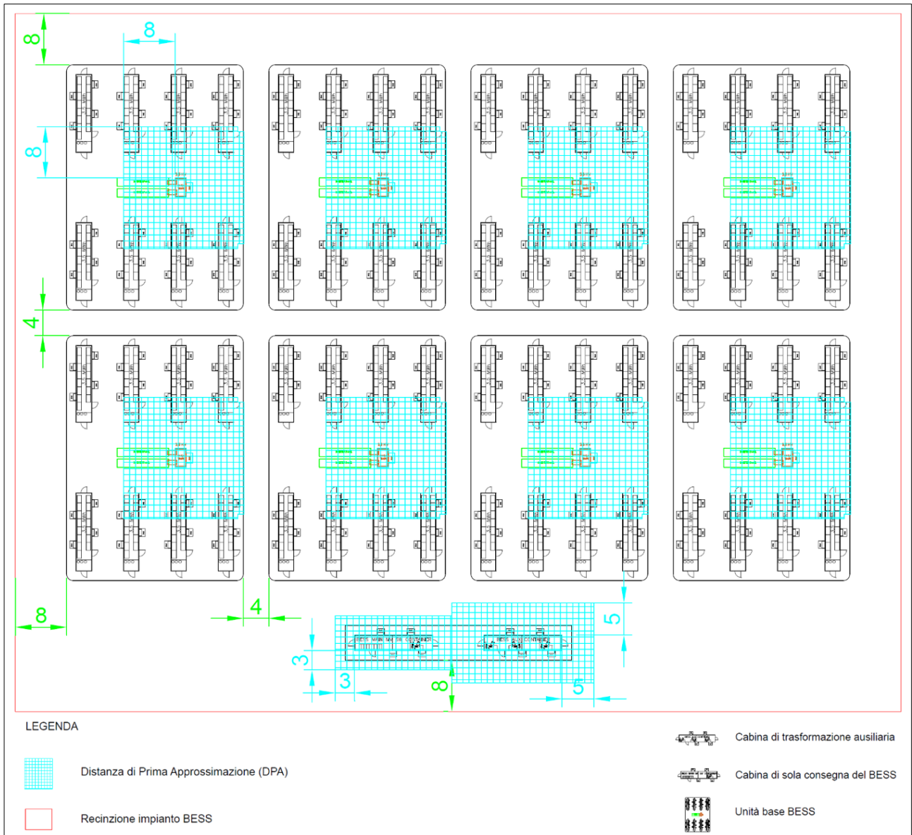
Figura 5.2.3: Layout impianto BESS con rappresentazione della DPA
