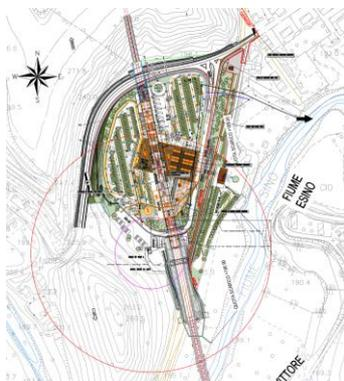
Figura 23 Stralcio elaborato IROF02R29PZID0000703A - planimetria idraulica drenaggio piazzale Genga
