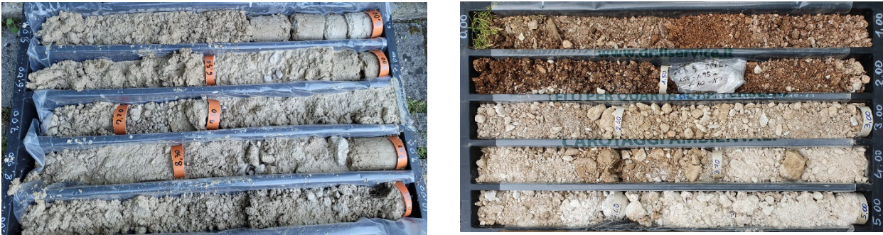
Figura 1 Sondaggio FCL22 (5-10 m da p.c.) e sondaggio FCS9 (0-5 m da p.c.)
