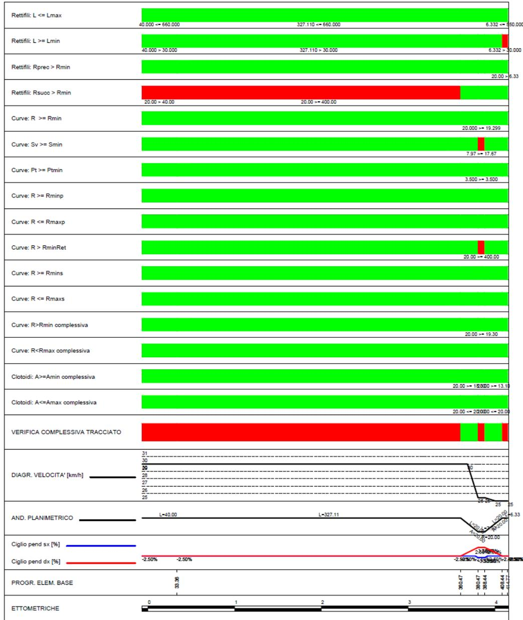
Si evidenzia che le criticità riguardano lunghezza dei rettilifi, sviluppo delle curve e rapporti lunghezza rettilifi - raggio delle curve, cioè criteri riguardanti la percezione ottica del tracciato. Le criticità sono dovute alle condizioni al contorno in cui è stata inserita la viabilità.
