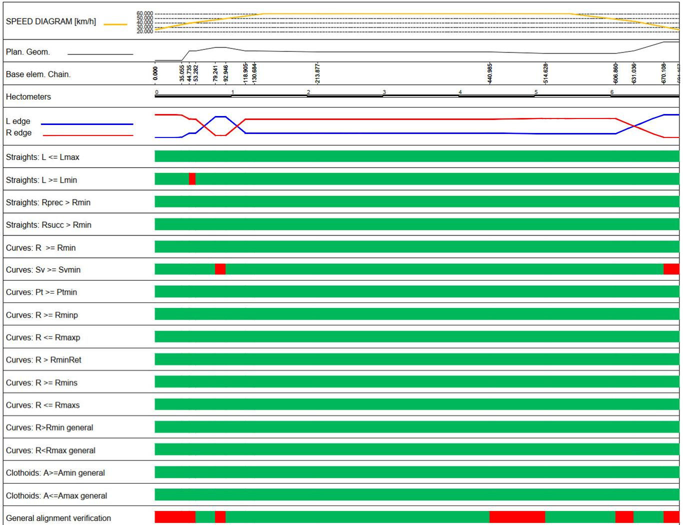
Si evidenzia che le criticità riguardano lunghezza dei rettifili e sviluppo delle curve, cioè criteri riguardanti la percezione ottica del tracciato. Le criticità sono dovute alle condizioni al contorno in cui è stata inserita la viabilità.
