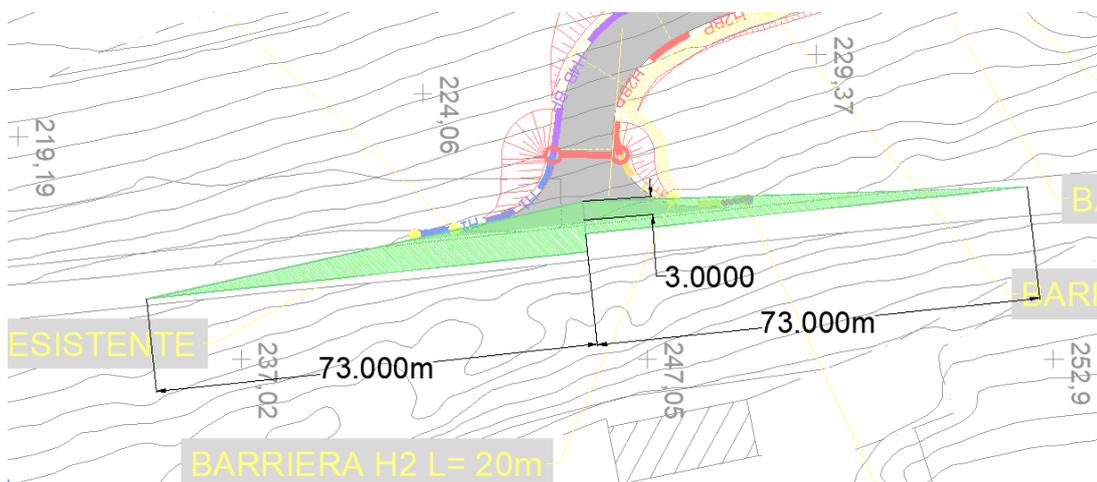
Si evidenzia che nell'area dei triangoli di visibilità risultano comprese le barriere di progetto, un muretto esistente di altezza esigua (max 60 cm cca. da celerimetrico) e della vegetazione in corrispondenza del pendio esistente (vedi img successiva). In questo caso per evitare problemi di visibilità occorrerà:
