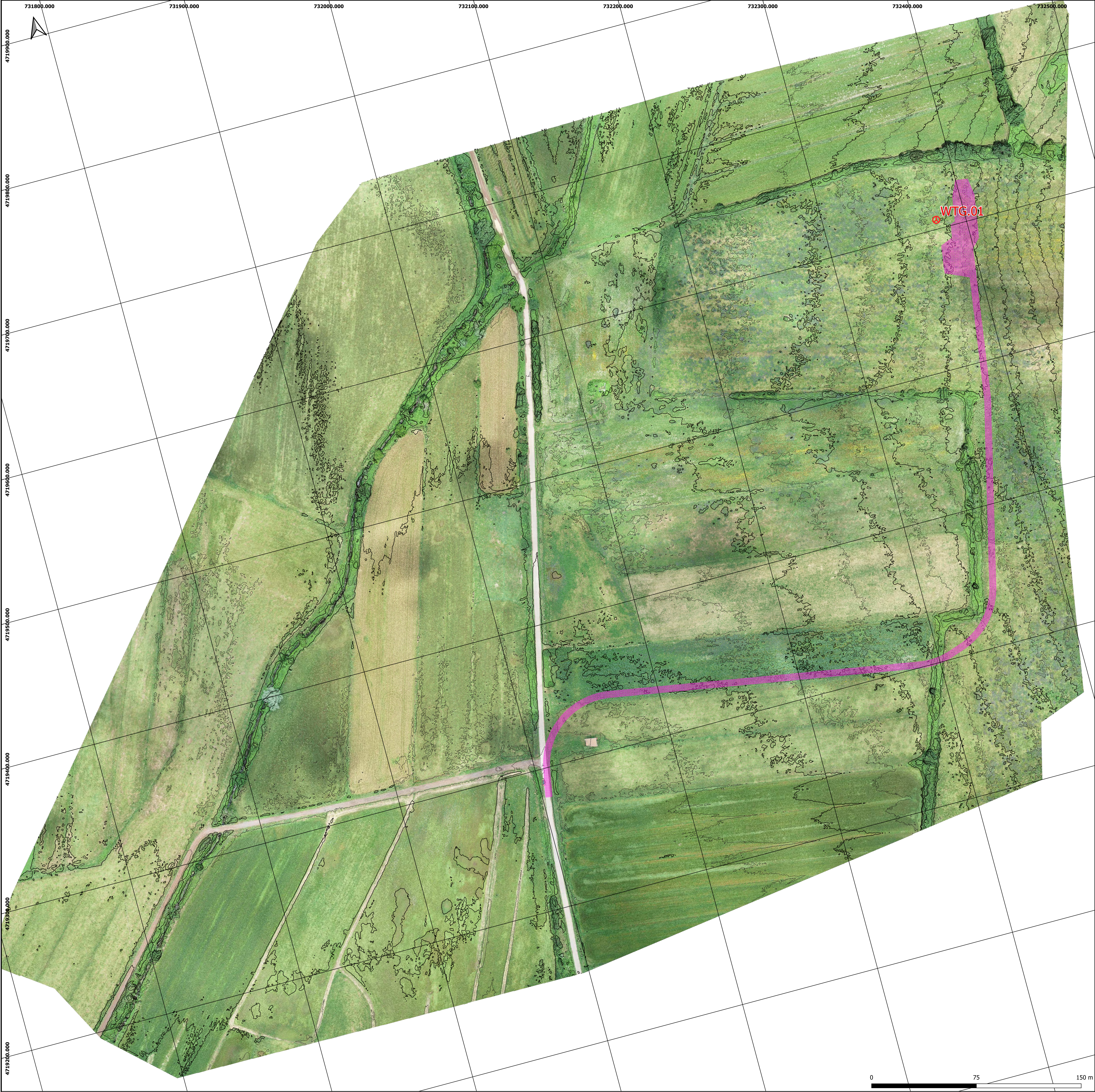
ORTOFOTO DA RILIEVO DRONE CON CURVE DI LIVELLO risoluzione foto 0.5 m/pixel - risoluzione DTM 0.5 m/pixel AREA WTG.01
