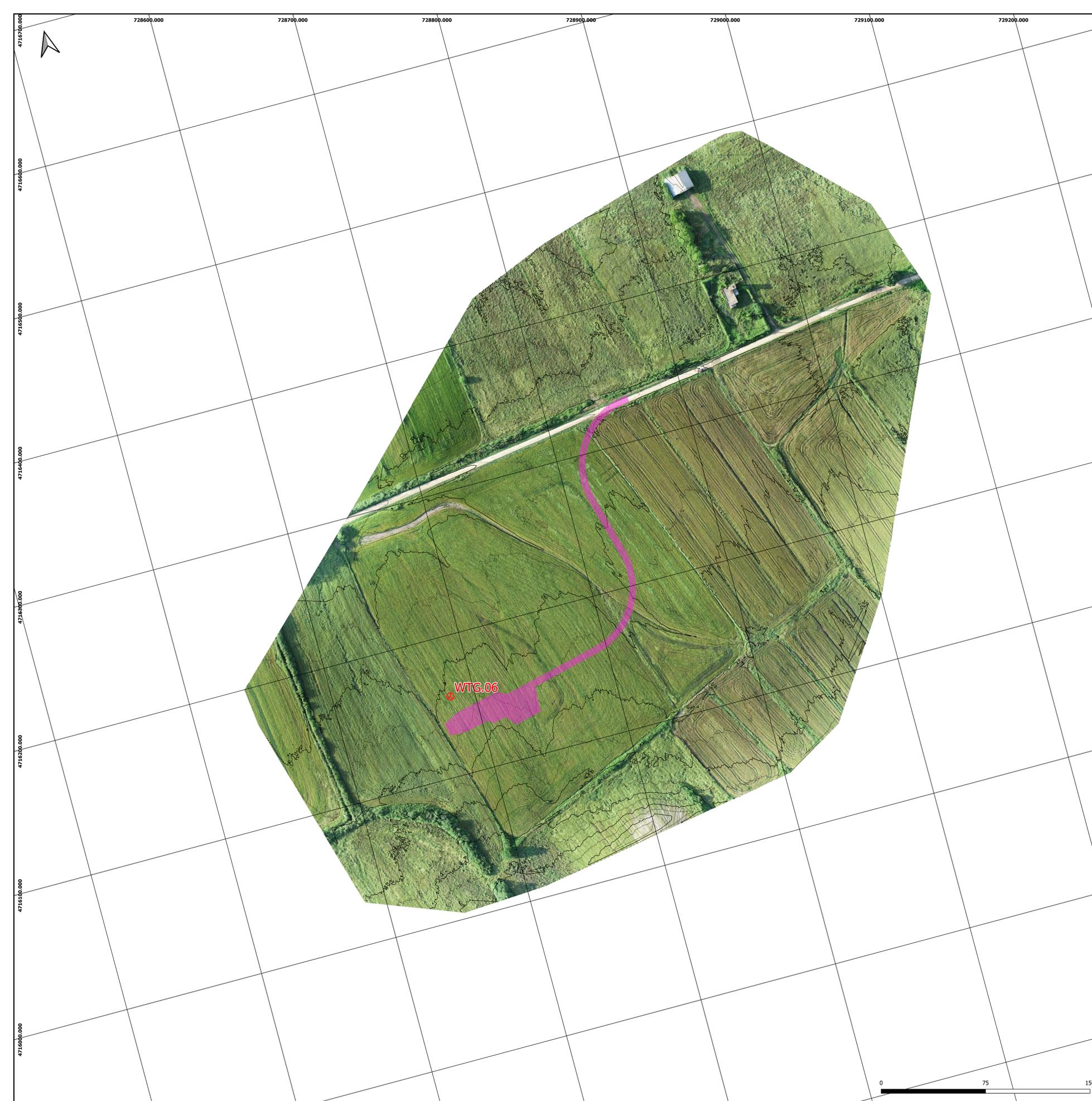
ORTOFOTO DA RILIEVO DRONE CON CURVE DI LIVELLO
