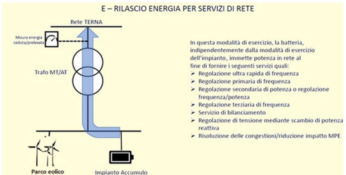
Figura 18 - Modalità di Funzionamento del Sistema di Accumulo di tipo E: Rilascio Energia per Servizi di Rete
