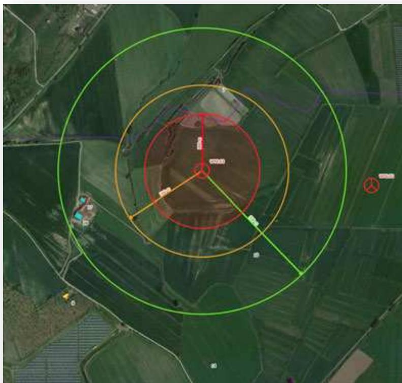
Figura 11 - Estratto elaborato n. EDP0024\_cA0 (Verifica delle distanze minime dell'impianto dai fabbricati 3 di 7)
