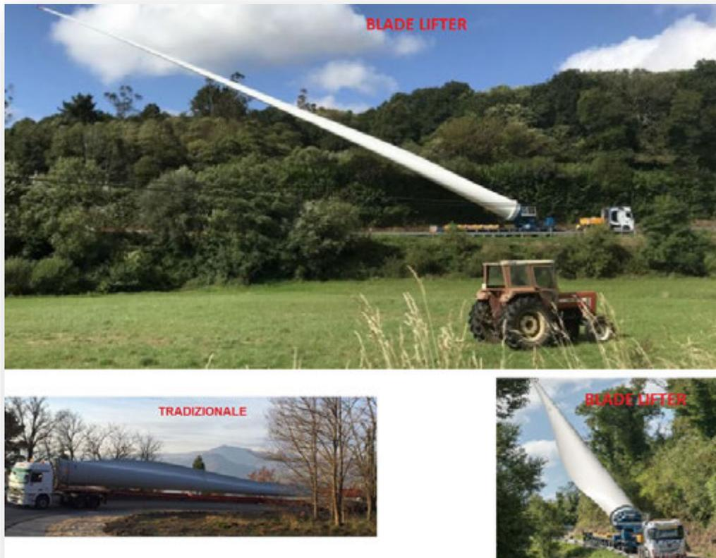
*Figura 26 – esempi di trasporto tradizionale e soluzione con cambio della configurazione di carico durante il percorso (blade lifter)*
