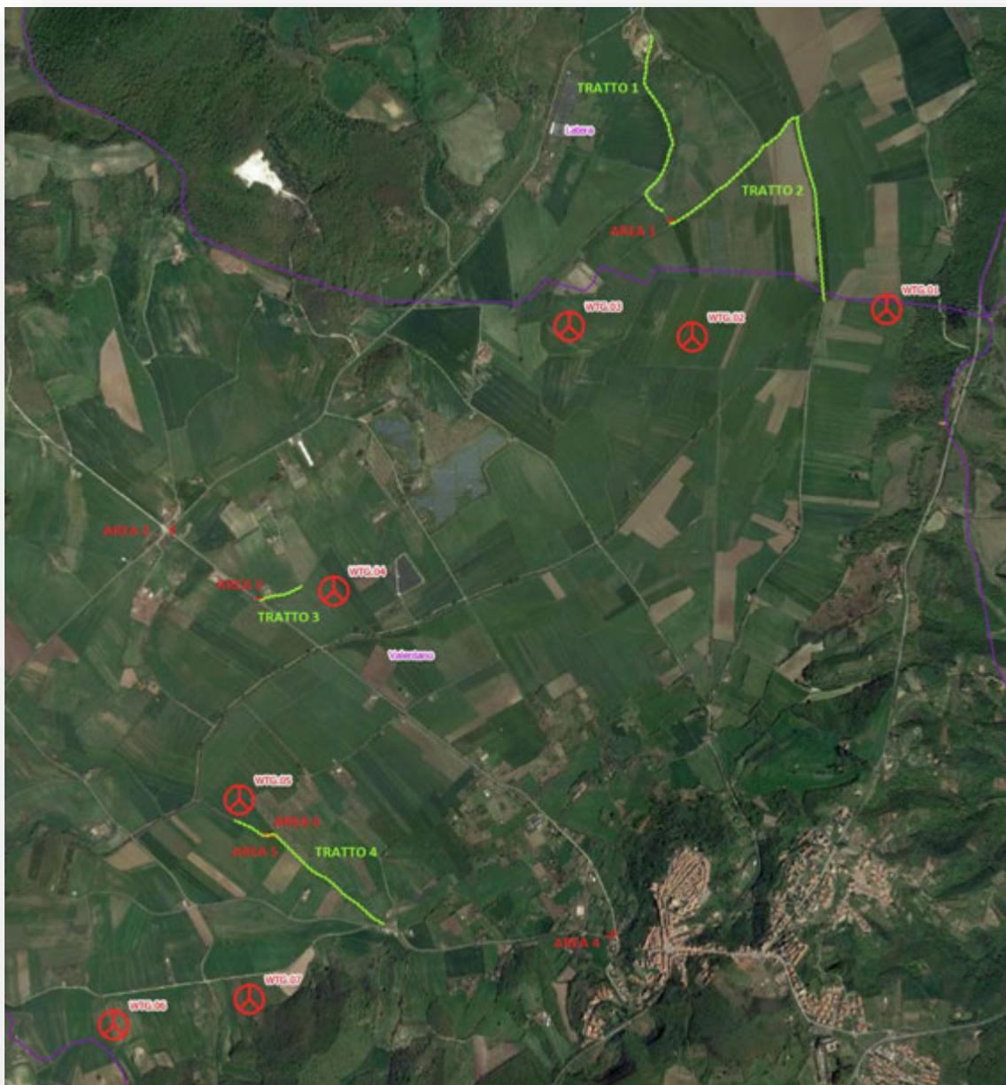
Figura 27 – Schema delle aree di viabilità esistente da adeguare
