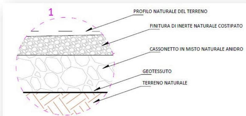
Figura 29 - schema rappresentativo del pacchetto stradale
