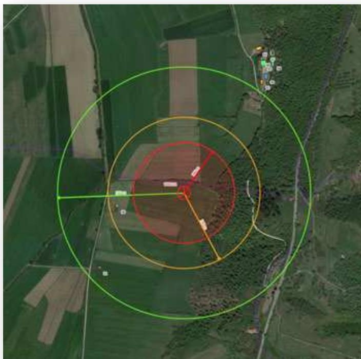
Figura 9 - Estratto elaborato n. EDP0024\_aA0 (Verifica delle distanze minime dell'impianto dai fabbricati 1 di 7)
