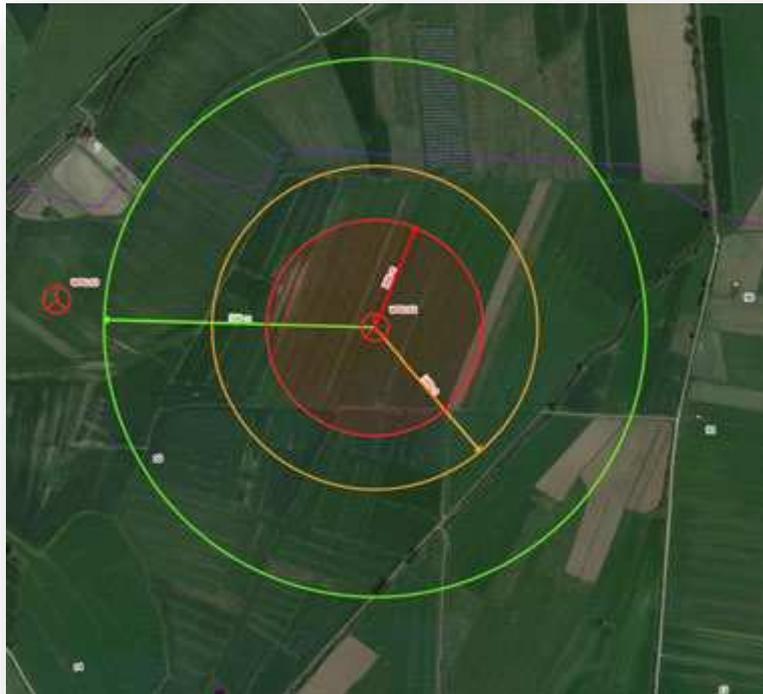
Figura 10 - Estratto elaborato n. EDP0024\_bA0 (Verifica delle distanze minime dell'impianto dai fabbricati 2 di 7)
