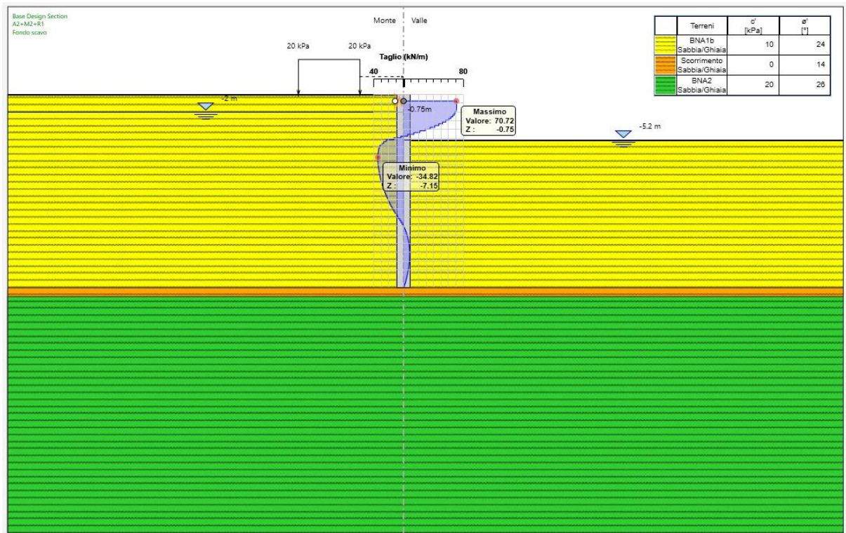
Figura 12-6 – Taglio in condizione statica SLU
