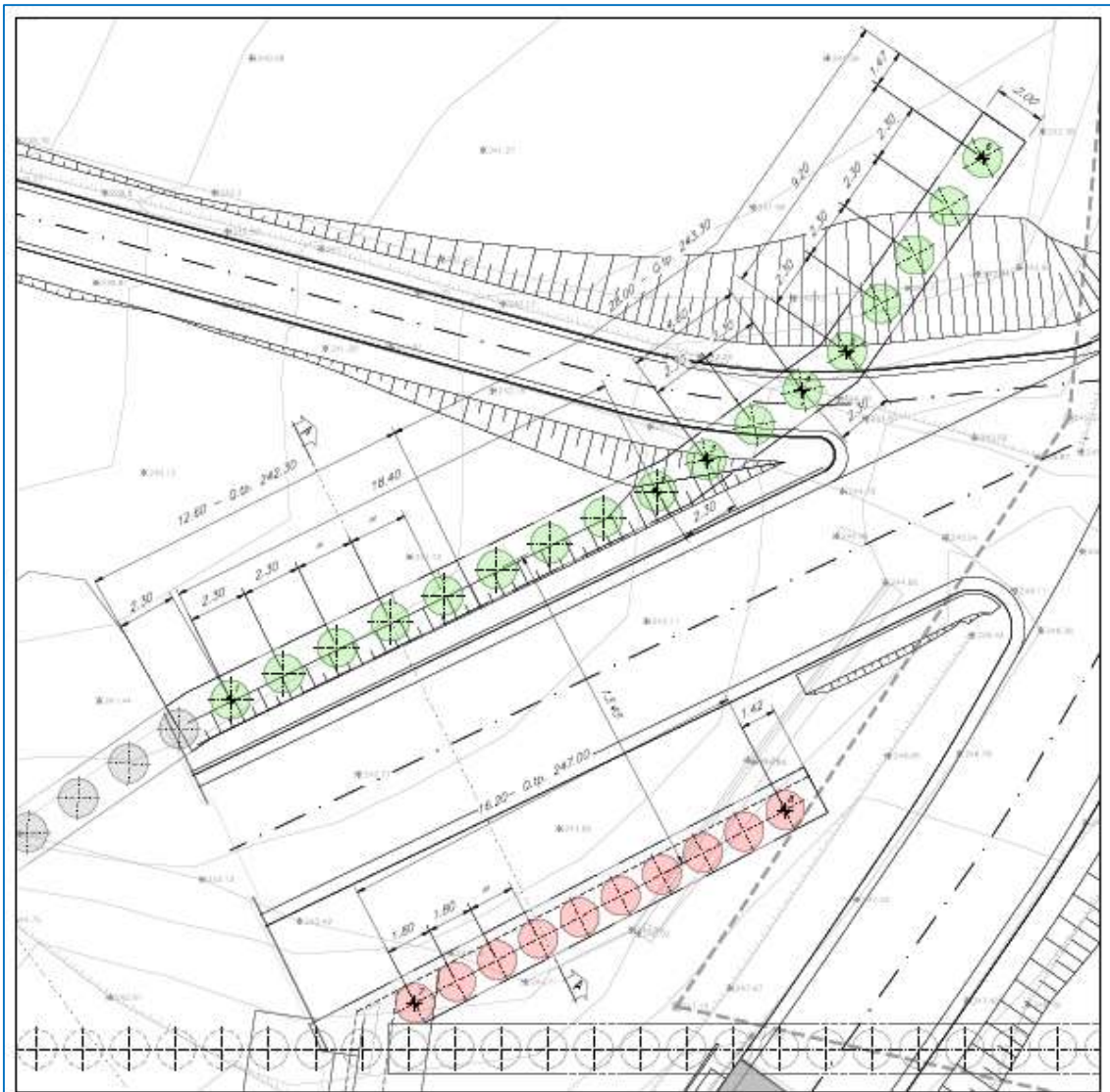
Figura 2-6 – Tracciamento pali NV11-A1 viabilità accesso al Piazzale RI57
