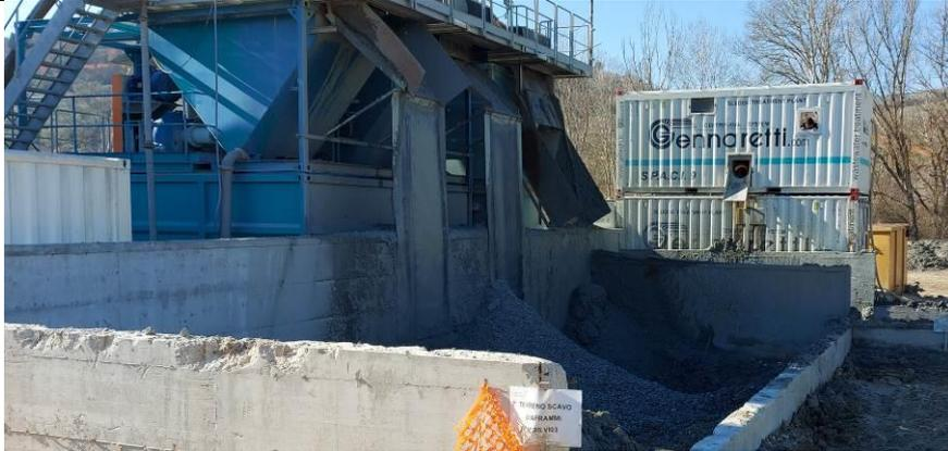
Figura 7 – Prodotti del dissabbiamento del fango bentonitico
