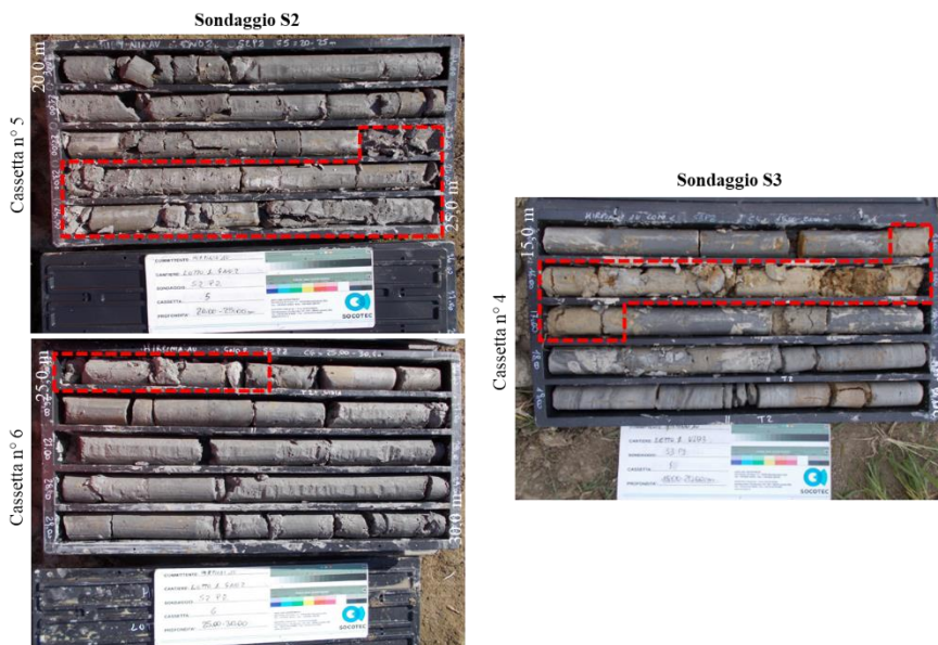
Figura 3-4 – Posizione dei livelli granulari all'interno dell'UG2 nelle verticali di sondaggio S3 e S2
