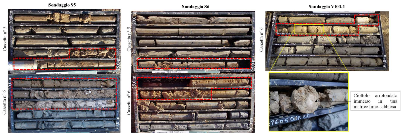
Figura 2-2 – Stratigrafia della verticale I_A
