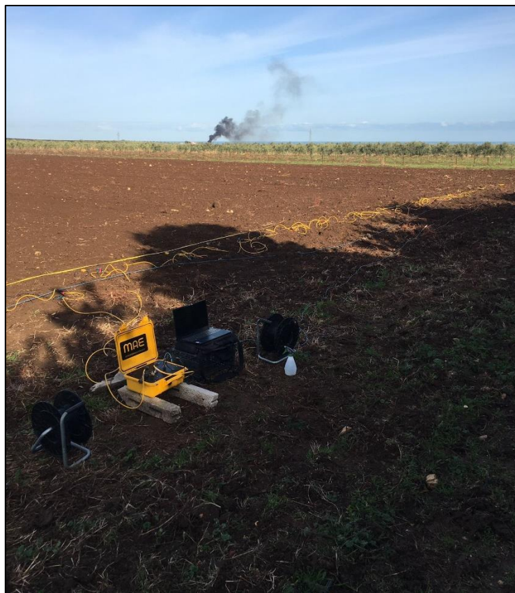
Particolare fase di acquisizione e registrazione tomografia R.F.1 e M.A.S.W. M.1
