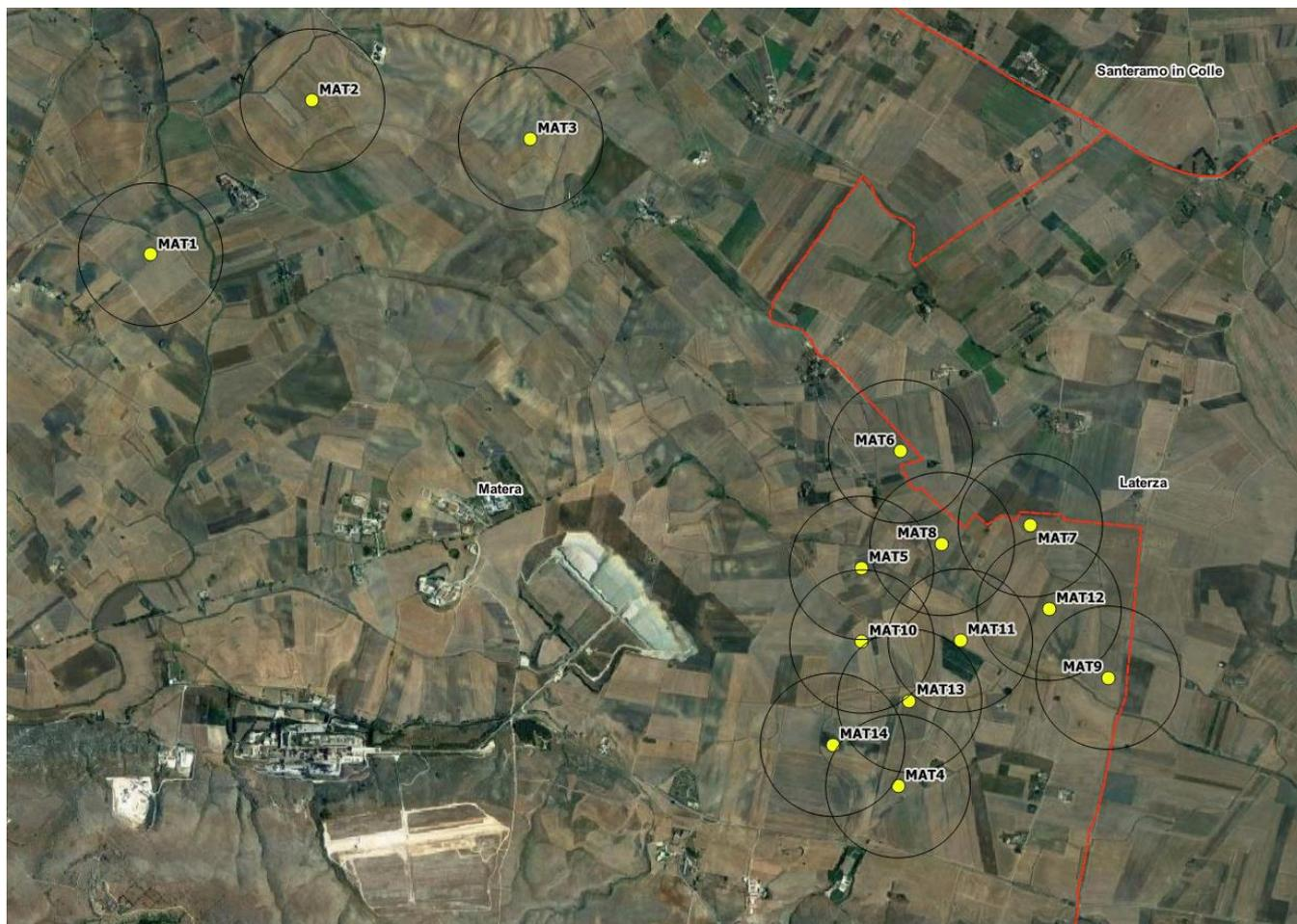
**Figura 11-2: Posizionamento di progetto delle 14 turbine (Alternativa 3)**
