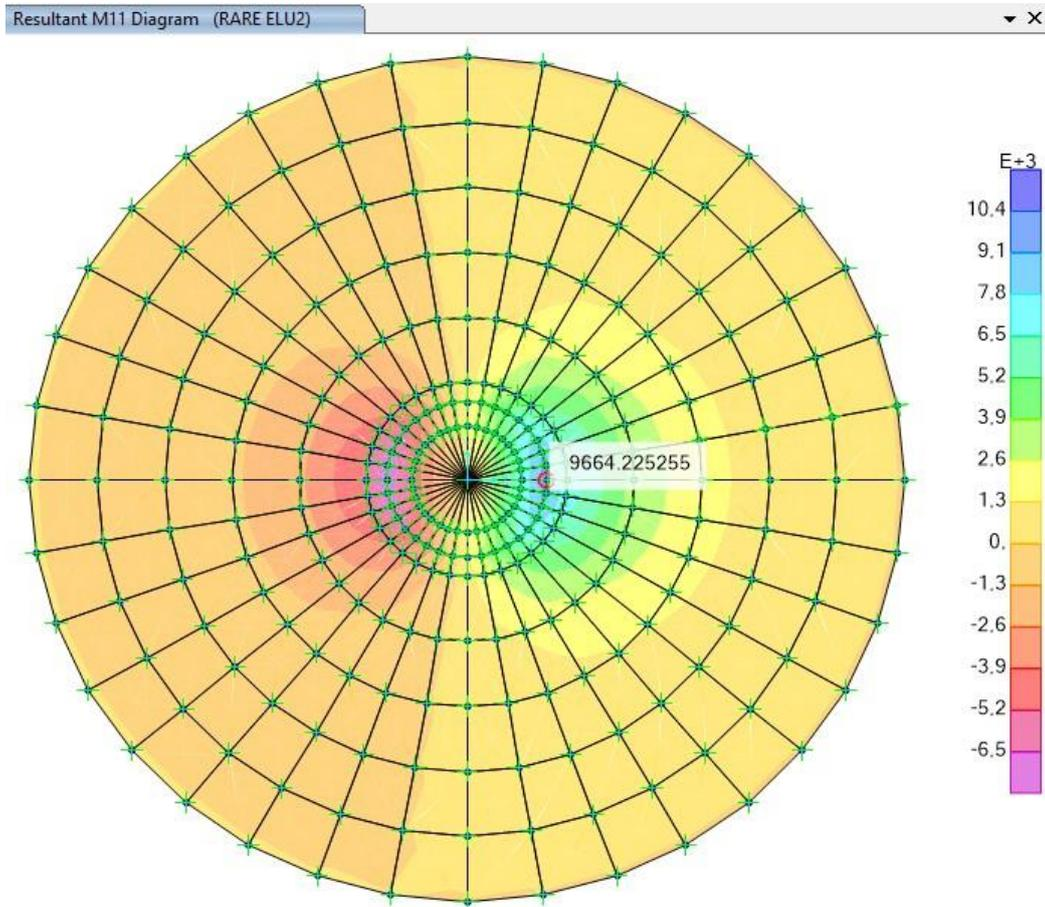
**Figura 9-3: Momento Massimo M<sub>11</sub> Normal SLU 2 [kNm/m]**
