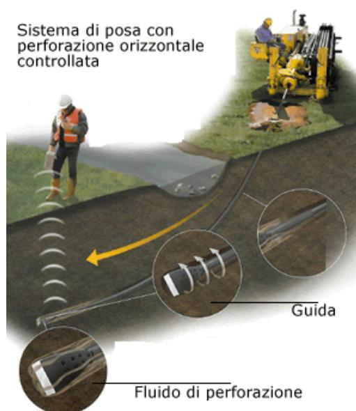
**Figura 13 Sistema di trivellazione orizzontale controllata (T.O.C.).**
