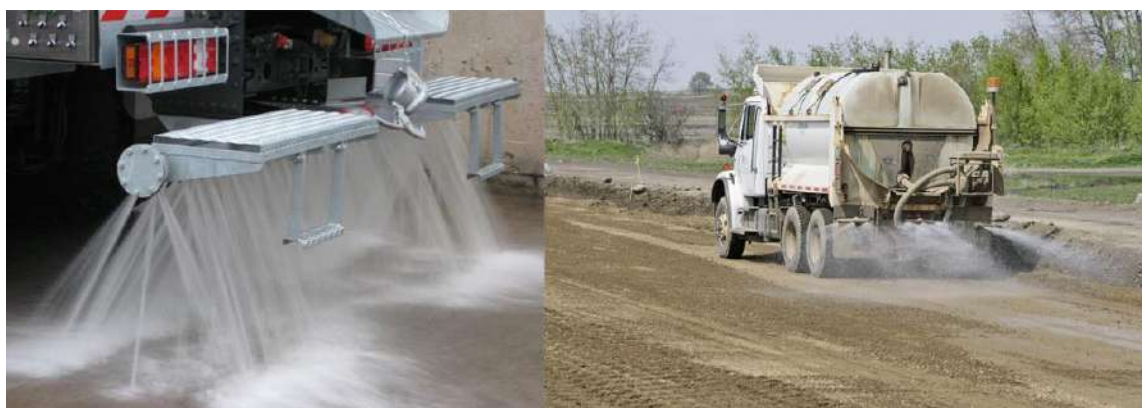
Figura 5-1: Automezzo per la bagnatura delle piste sterrate
