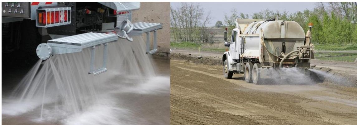
**Figura 5-1: Automezzo per la bagnatura delle piste sterrate**
