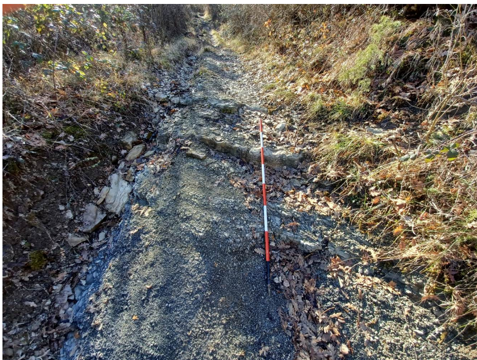
Figura 3-13 Sequenza di peliti dominanti e strati arenace (spessore medio 5 cm), della potenza complessiva di 5 m, presso la località C. Valdivatica, a monte del tratto terminale del tracciato
