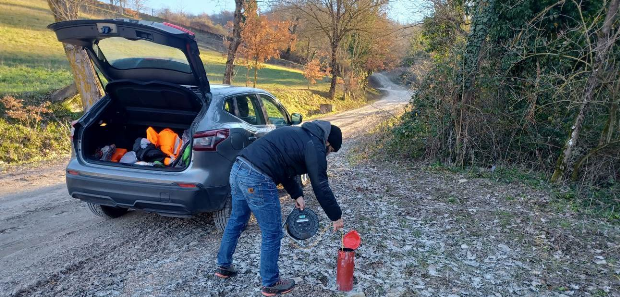
Foto 8-1 Misura piezometrica S8 durante il rilievo di geologico di dettaglio
