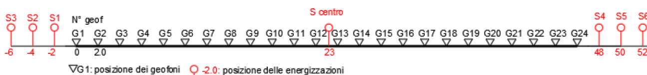
Figura 32 Schema geometrico di acquisizione dei dati per gli stendimenti di lunghezza L = 46,0 m
