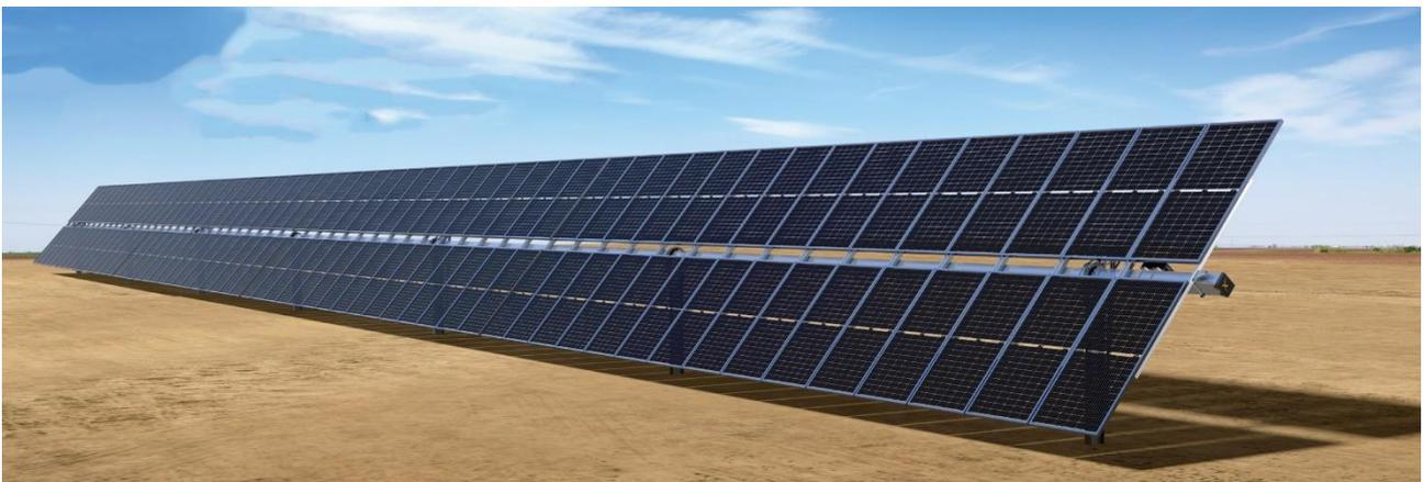
Figura 4: trackers tipo con pannelli installati.
