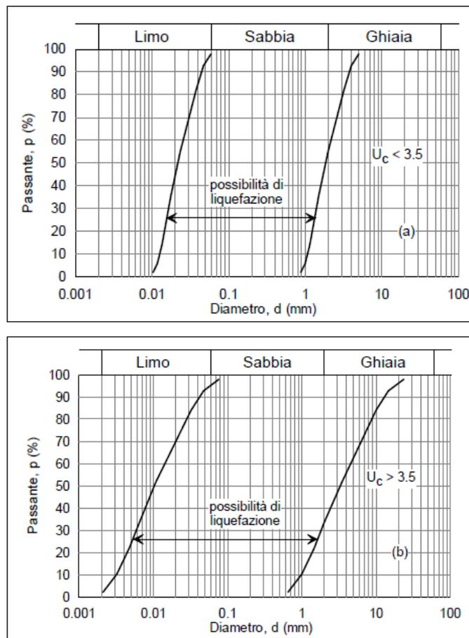
Figura 33 – Fusi granulometrici di terreni suscettibili di liquefazione
