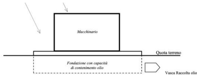
Figura 2 - Rappresentazione schematica del sistema Vasca-Fondazione
