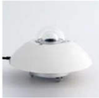
Figura 13: Piranometro e classi di precisione
