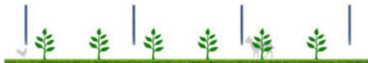
Figura 9: Sistema agrivoltaico in cui i moduli fotovoltaici sono disposti verticalmente. La coltivazione avviene tra le file dei moduli fotovoltaici, l'altezza minima dei moduli da terra influenza il possibile passaggio di animali (TIPO 3).
