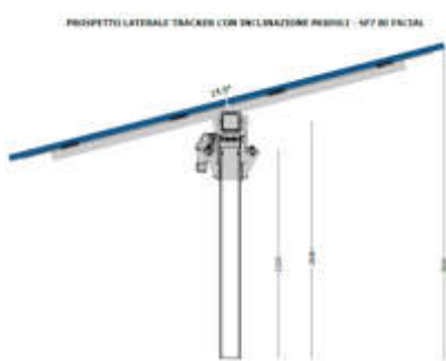
Figura 13: Inclinazione pannelli 14,5° sull'orizzontale
