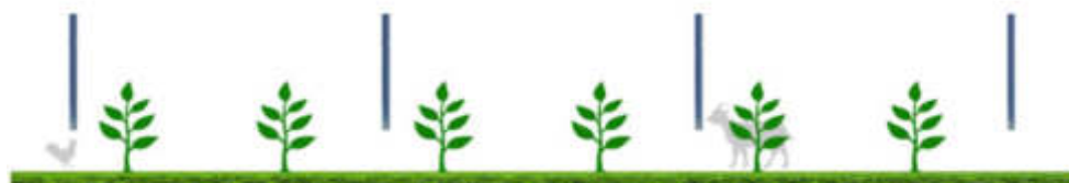
Figura 3: Sistema agrivoltaico in cui i moduli fotovoltaici sono disposti verticalmente. La coltivazione avviene tra le file dei moduli fotovoltaici, l'altezza minima dei moduli da terra influenza il possibile passaggio di animali (TIPO 3)
