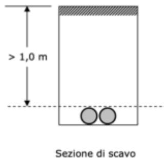
Figura 94: Profondità minima dell'elettrodotto
