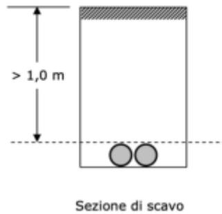
**Figura 2: Profondità minima dell'elettrodotta**
