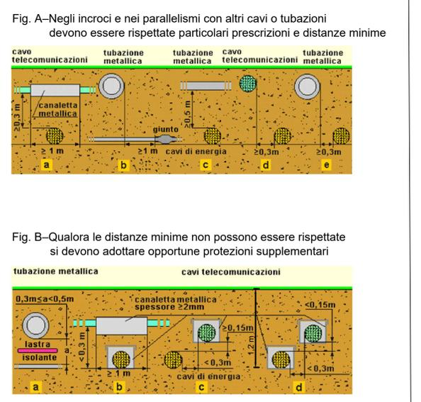
**Fig. C - Distanze minime con altri cavi, tubazioni metalliche, serbatoi e cisterne di carburante.**
