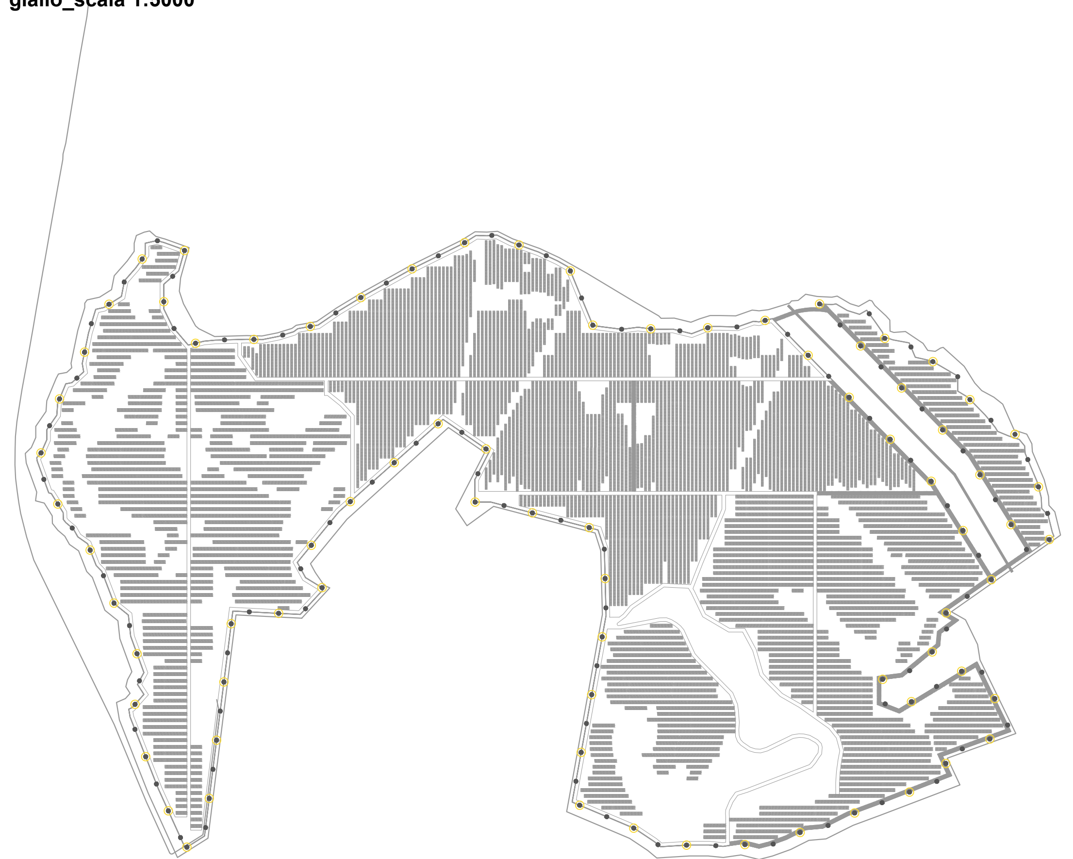
Schema impianto agrivoltaico con pali illuminazione e videosorveglianza in giallo_scala 1:5000
