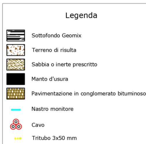
**Figura 12** – Materiali di riempimento per scavo cavi esterni
