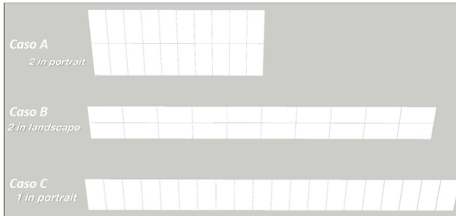
Figura 5 – Differenti configurazioni degli inseguitori solari monoassiali
