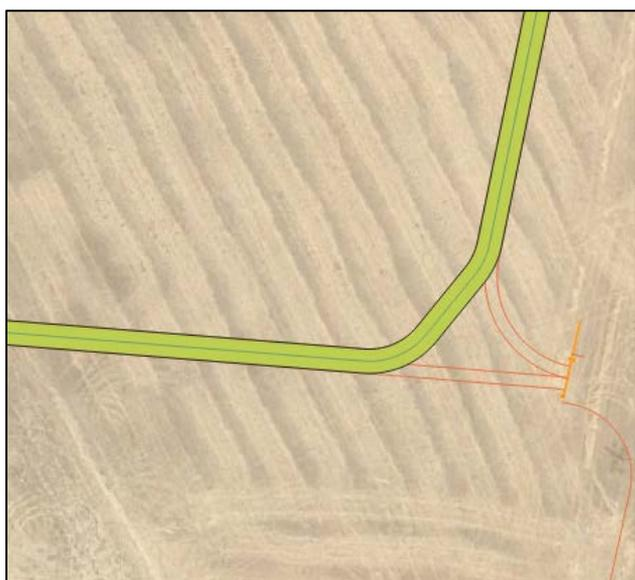
Le strade interne sono realizzate mediante strato di misto granulometrico largo 4 m, mentre il raccordo di ingresso è asfaltato per i primi 4 m lungo tutta la sua larghezza.
