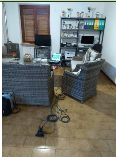
Posizionamento accelerometro monoassiale, 1° piano f.t.
